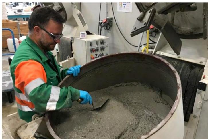
Pour réaliser l'ensemble de la superstructure en béton entièrement recyclé - les voiles intérieurs et extérieurs, les façades matricées et les dalles des toitures-terrasses -, Holcim a travaillé à la définition d'une formule permettant de répondre aux prescriptions du cahier des charges, à savoir un béton C25/30 S4.
